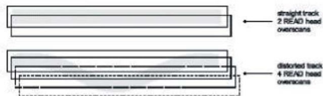
Figura 2 - L'overscanning garantisce che ogni pacchetto venga letto indipendentemente dall'allineamento della traccia rispetto alla testina; se una testina perde un pacchetto, questo verrà letto dalla testina successiva.
